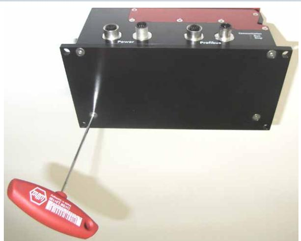
2. Stellen Sie mit den Drehschaltern A und B die gewünschte Busadresse ein. Die Pfeilspitze des Drehschalters muss auf die entsprechende Ziffer zeigen.
